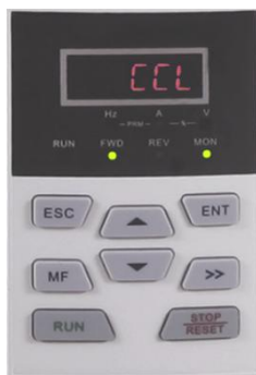
图 4-4 故障告警显示状态图（CCL：接触器吸合故障）
