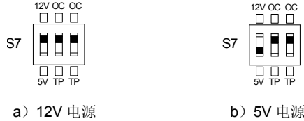
图 3-26 开路集电极输出型编码器 S7 拨码方式
