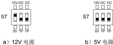
图 3-30 差分输出型编码器 S7 拨码方式
