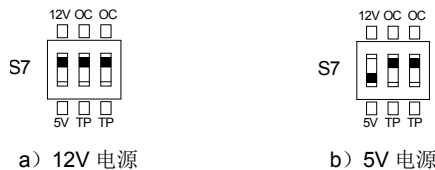
图 3-28 推挽输出型编码器 S7 拨码方式
