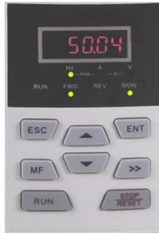
图 4-7 直接频率修改状态图
