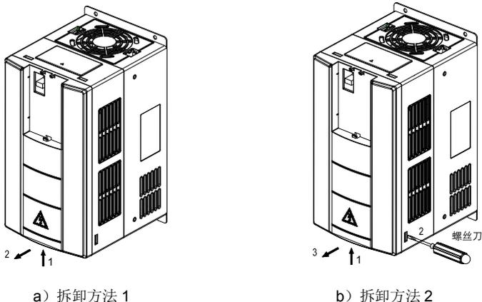
图 3-6 盖板的拆卸
