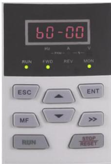
图 4-5 功能码序号编辑状态图
