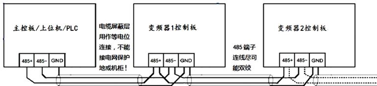
图 3-26 RS485 通讯端子连接图
