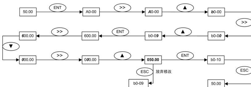
图 4-12 修改频率上限流程图
