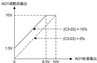
图 6-35 AO1 零偏对输出的影响关系图
