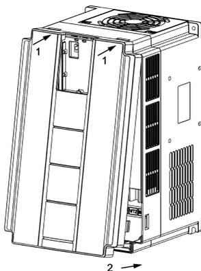
图 3-9 盖板的安装
