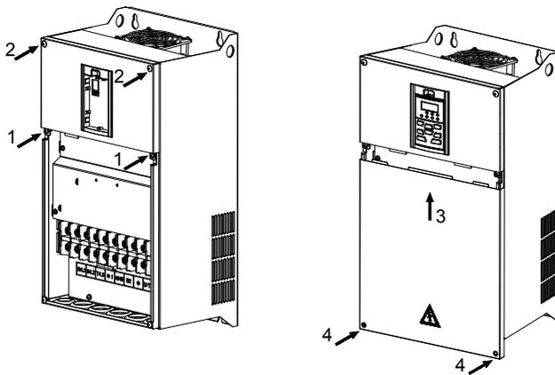
图 3-11 上下盖板的安装
