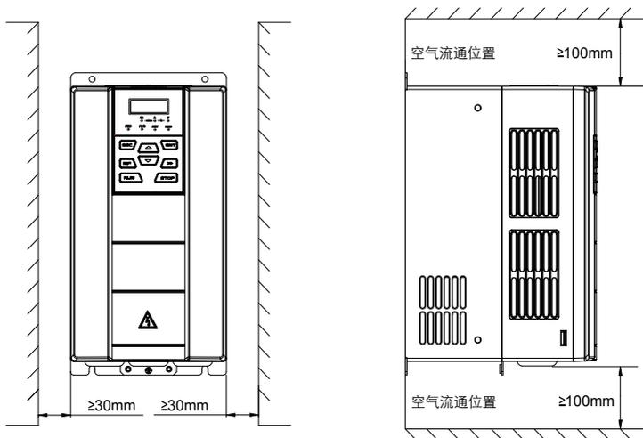
图 3-1 GK620-4T22G/30LB 及以下功率等级的安装方向和空间要求
