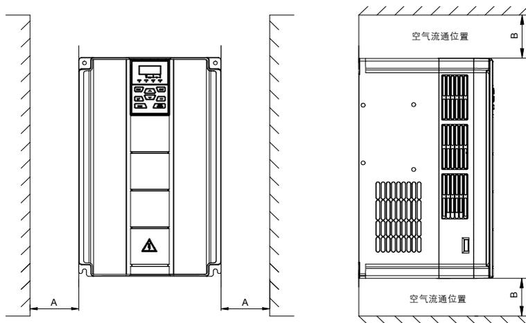
图 3-2 GK620-4T30G/37L(B/D/H)~GK620-4T37G/45L(B/D/H)安装方向和空间要求
