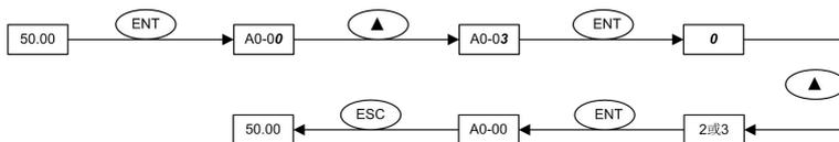
图 4-13 用户参数初始化流程图
