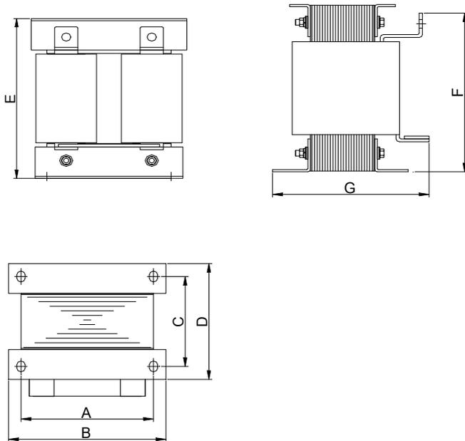
图 3-13 外置直流电抗器外形尺寸图
