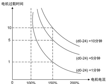
图 6-39 普通电机 50Hz 运行的电机保护曲线
