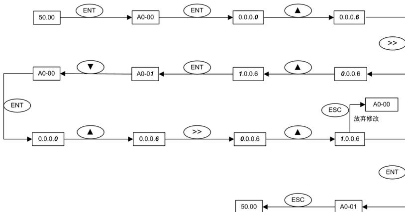
图 4-11 用户密码设置流程图
