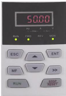
图 4-3 运行参数显示状态图（显示运行频率 50Hz）
