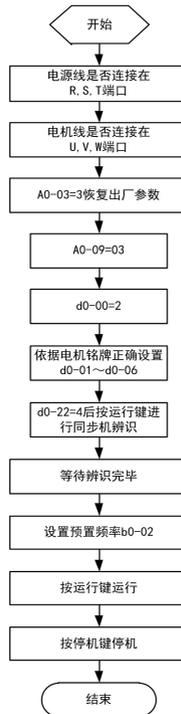
图 4-18 同步电机首次上电流程图
