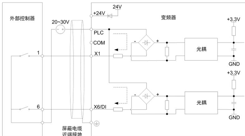
图 3-19 使用外部电源干接点方式
