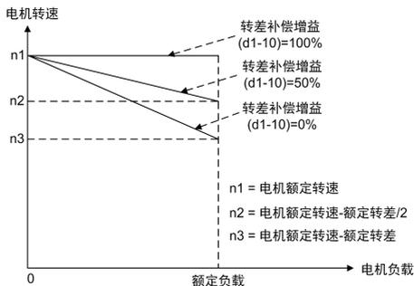
图 6-44 电动机时的转差补偿示意图
