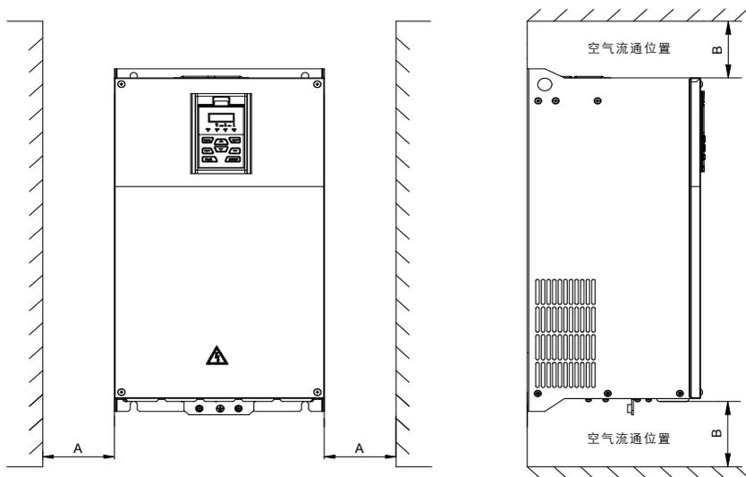
图 3-3 GK620-4T45G/55L(B)及以上功率等级的安装方向和空间要求
