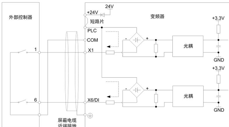
图 3-18 使用内部电源干接点方式
