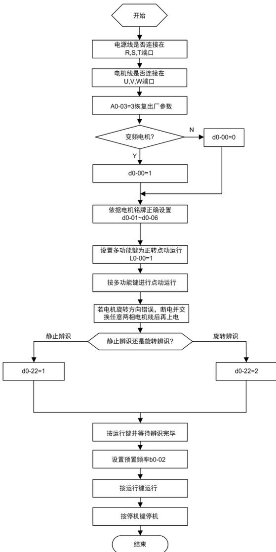
图 4-17 异步电机首次上电流程图
