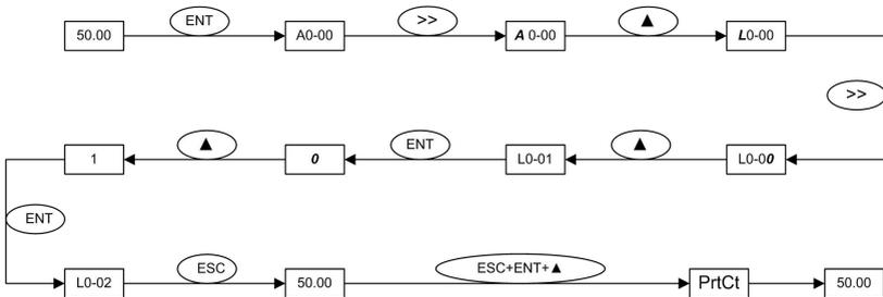
图 4-15 操作面板锁定流程图
