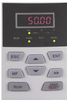
图 4-2 停机参数显示状态图（显示设定频率 50Hz）
