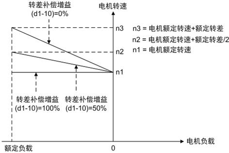
图6-45 制动时的转差补偿示意图
