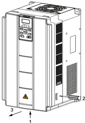
图 3-8 盖板的拆卸
