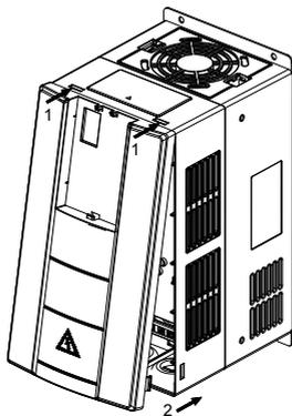
图 3-7 盖板的安装
