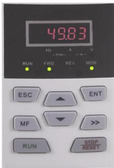
图 4-6 功能码参数设置状态图（设置 b0-02=49.83Hz）
